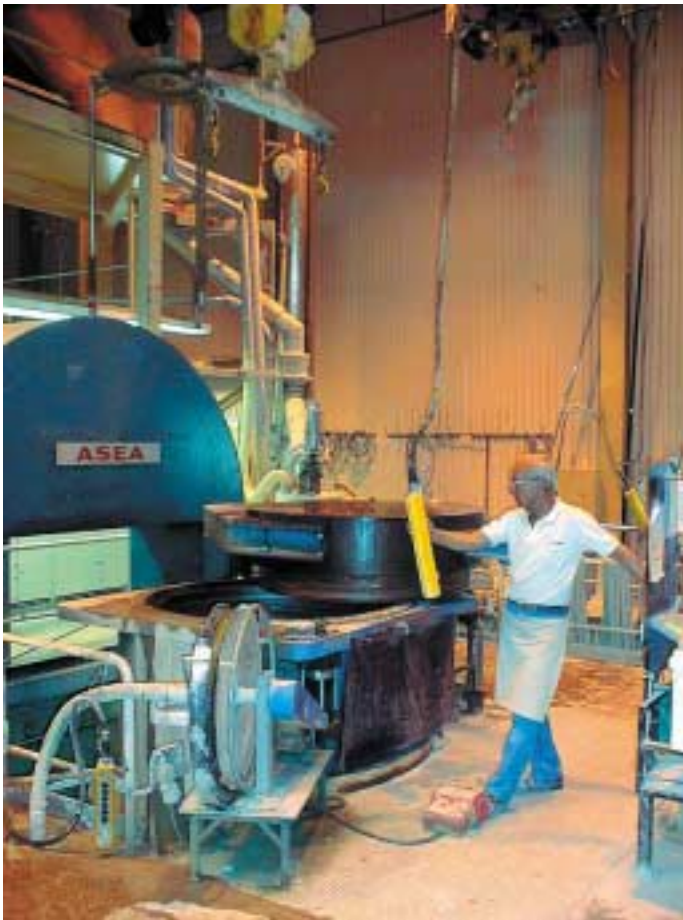
Figur 6-20. Isostatisk pressning av isolatorer vid Ifö Ceramics i Bromölla.
