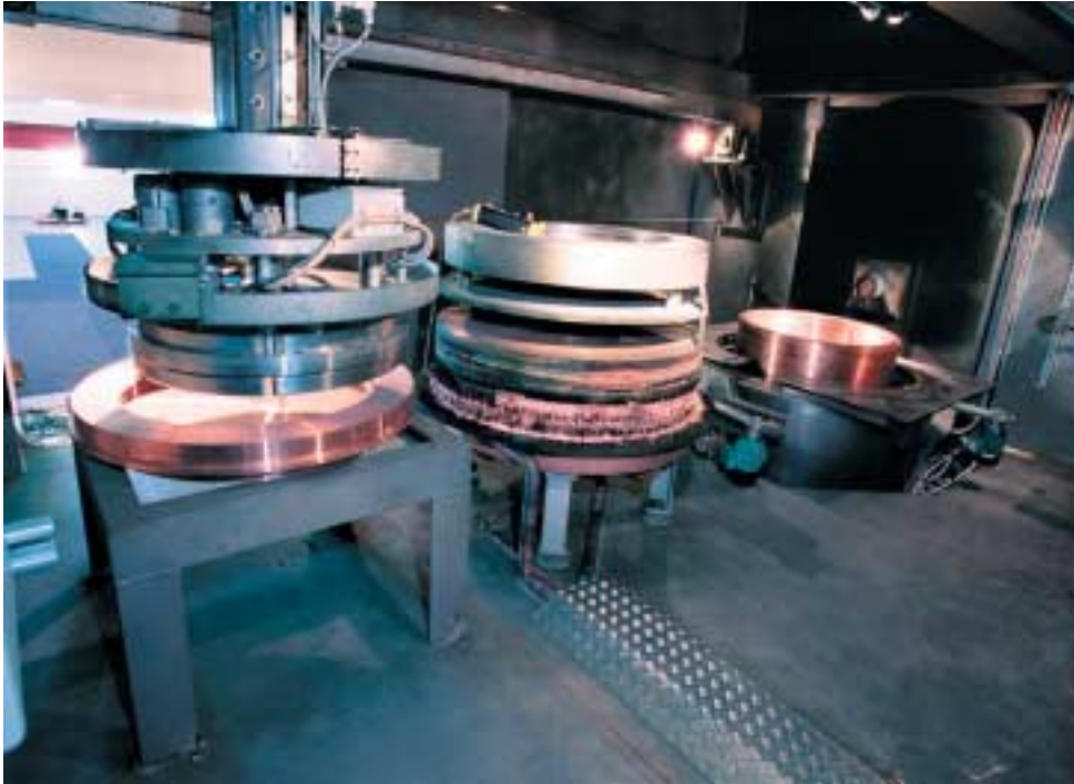
Figur 4-3. Bild från kapsellaboratoriet, insidan av svetskammaren med svetspositionen till höger.
