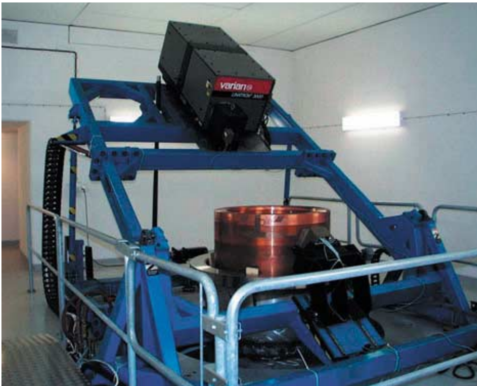
Figur 4-4. Bild från kapsellaboratoriet. Station för röntgenundersökning av kapsellokets förslutningssvets.
