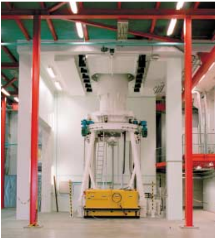
Figur 4-5. Bild från kapsellaboratoriet. Utrustning för förflyttning av kapslar mellan arbetsstationerna.
