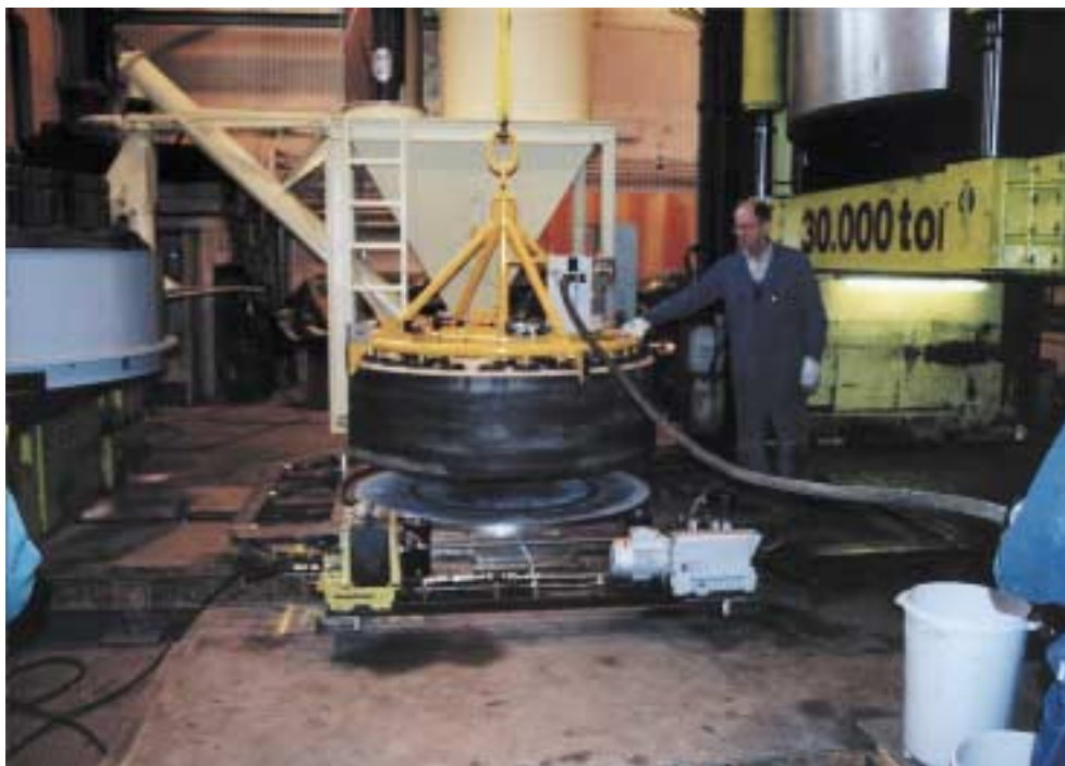
Figur 6-19. Bild från pressningen av bentonitbufferten hos Hydroweld i Ystad.
