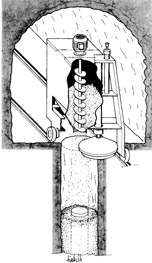
FYLLNING AV BUFFERTMATERIAL
