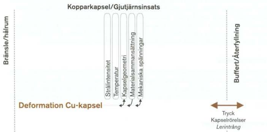
Figur 3-6. Deformation av kopparkapsel från yttre övertryck.
