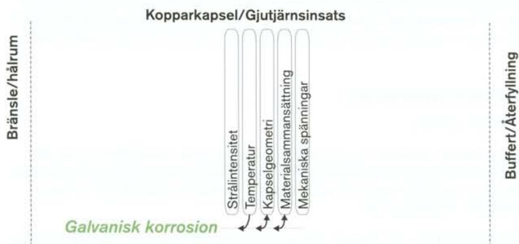
Figur 3-10. Galvanisk korrosion. Processen är endast relevant då kopparkapseln är skadad.
