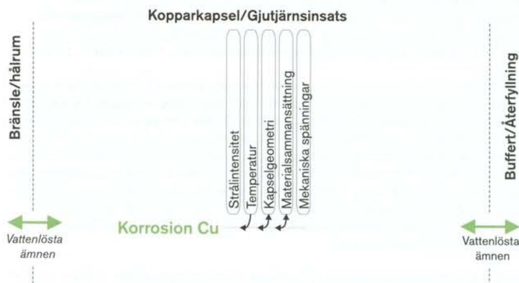
Figur 3-13. Korrosion av kopparkapseln.
