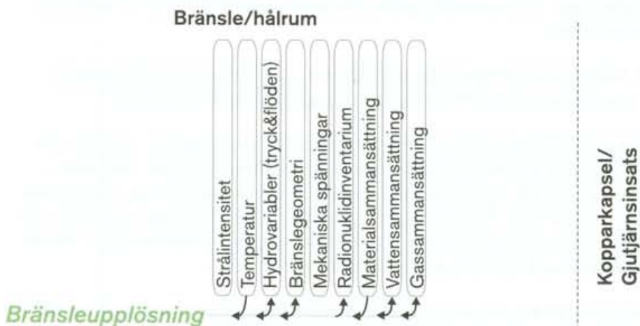
Figur 2-12. Bränsleupplösning. Processen är endast relevant då kopparkapseln är skadad.
