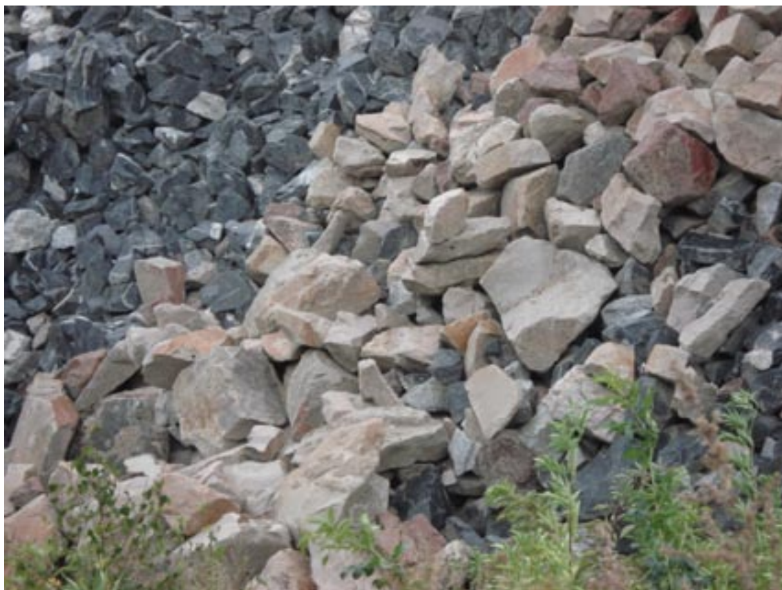
Figur 4-1. Tunnelberg utgörs av utsprängda och okrossade bergmassor.
