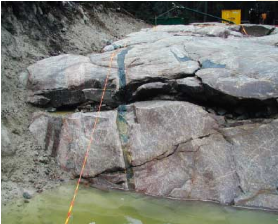
Exempel på en horisontell spricka fylld med glaciala sediment. Bilden är från borrplats fem. Se borrplatskarta på sidan 108.
