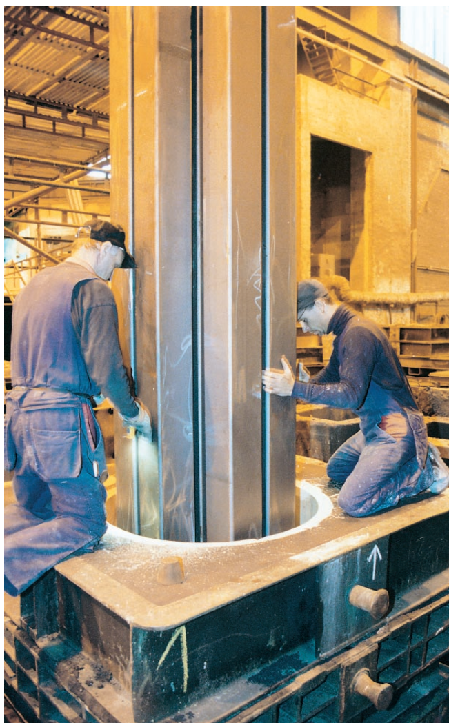
Figur 7-8. En svetsad kassett för BWR-bränsle placeras i gjutformen.
