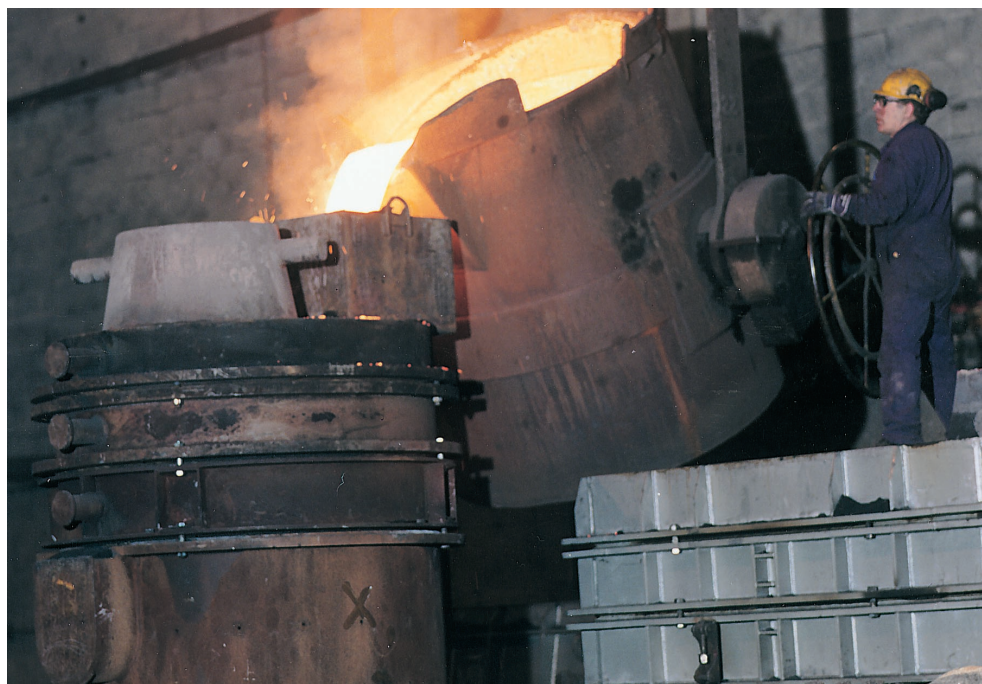
Figur 7-9. Gjutformen fylls med smält järn.
