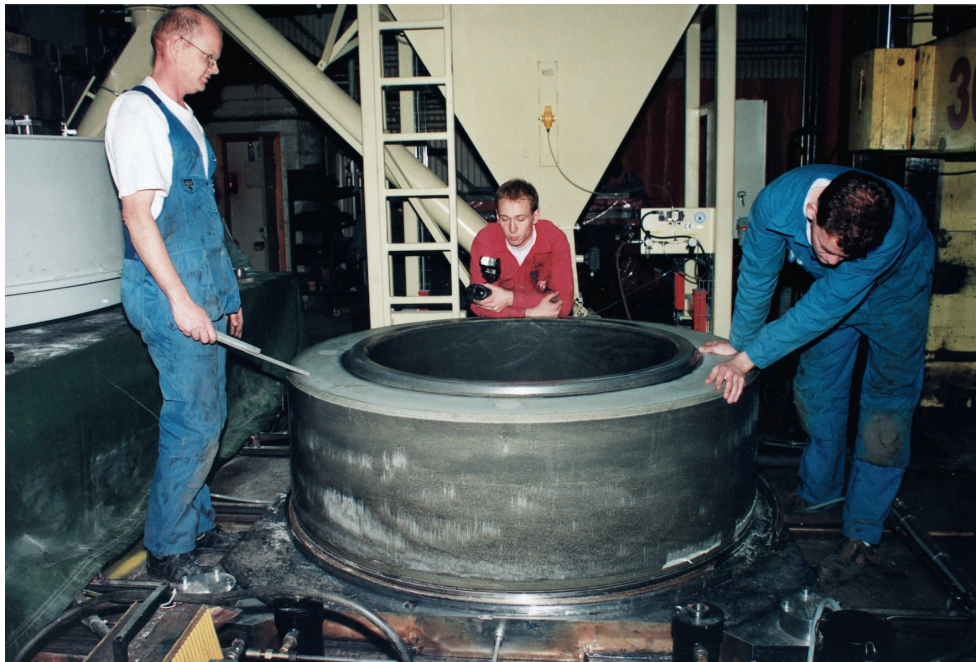
Figur 7-5. Ringformat bentonitblock i full skala (ytterdiameter 1,65 m, höjd 0,5 m) tillverkat med enaxlig pressning. Block av denna typ kommer att användas för fullskaleförsöken vid Äspölaboratoriet.
