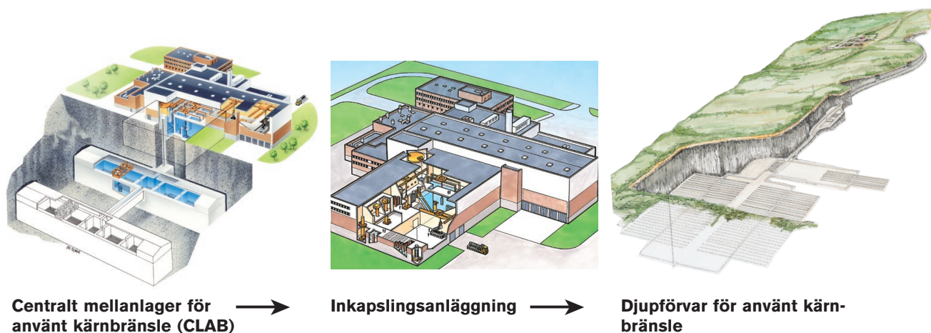
Figur 2. Kärntekniska anläggningar i det planerade djupförvarssystemet.
