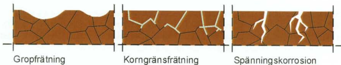
Figur 9-5: Olika typer av lokala korrosionsangrepp, från höger till vänster: gropfrätning, korngränsfrätning och spänningskorrosion.
