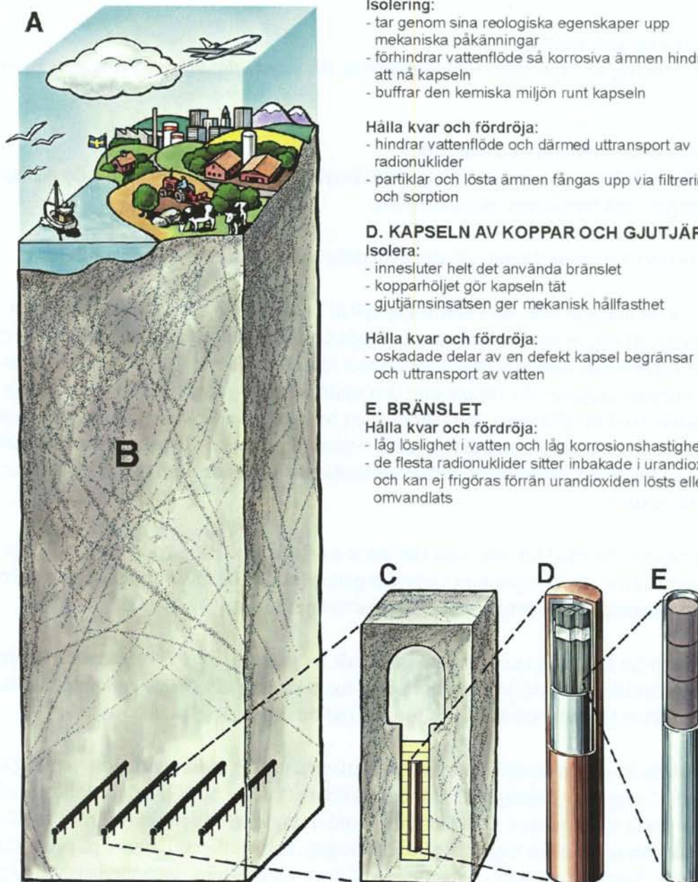
Figur 2-1: Förvarssystemet. Förvarssystemets olika delar, de olika barriärernas funktion och biosfärens betydelse för förvarets funktion.
