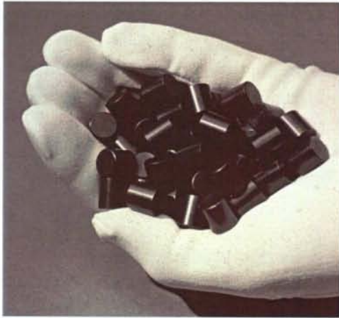
Figur 5-2: Till vänster: Kärnbränslekulsar av urandioxid. Bränslekulsarna placeras i rör av zirkaloy, s k bränslestavar. Till höger: Ett bränsleelement för en kokvattenreaktor. 64 bränslestavar sätts ihop till ett bränsleelement. I en kokvattenreaktor finns 440–700 bränsleelement, varje år byts ca en femtedel av elementen. Före driften i reaktorn kan bränslet hanteras utan strålskyddsåtgärder.
