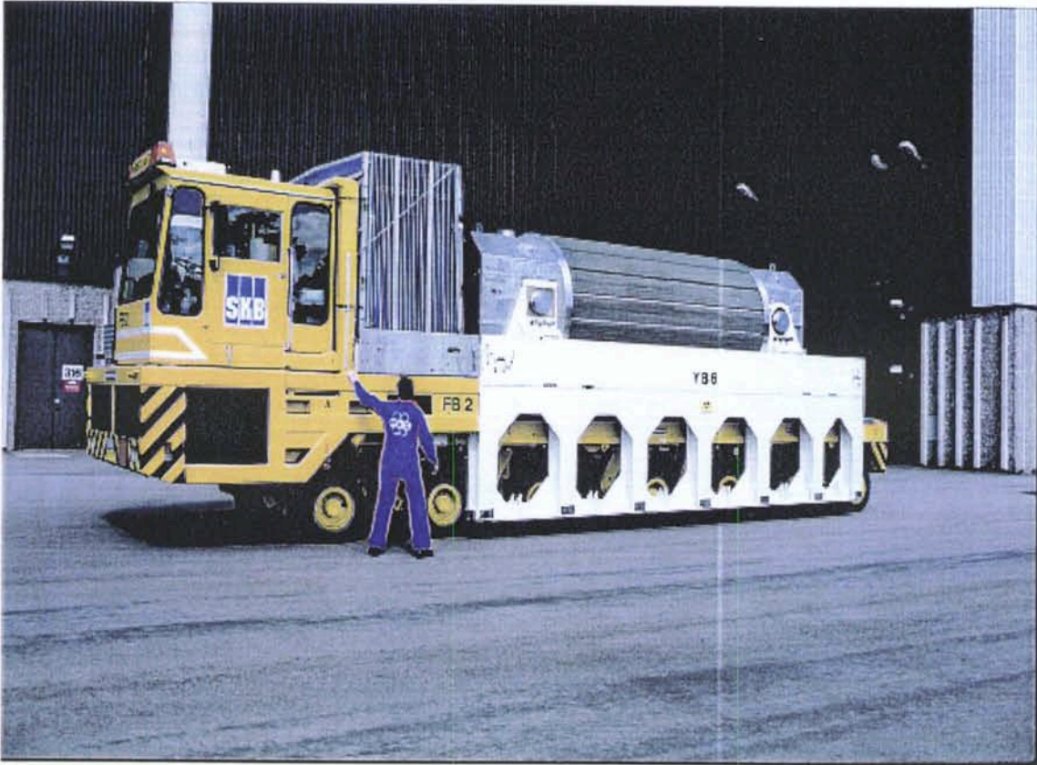
Figur 5-2. Specialkonstruerat terminalfordon med lastbärare för transportbehållare för använt kärnbränsle.
