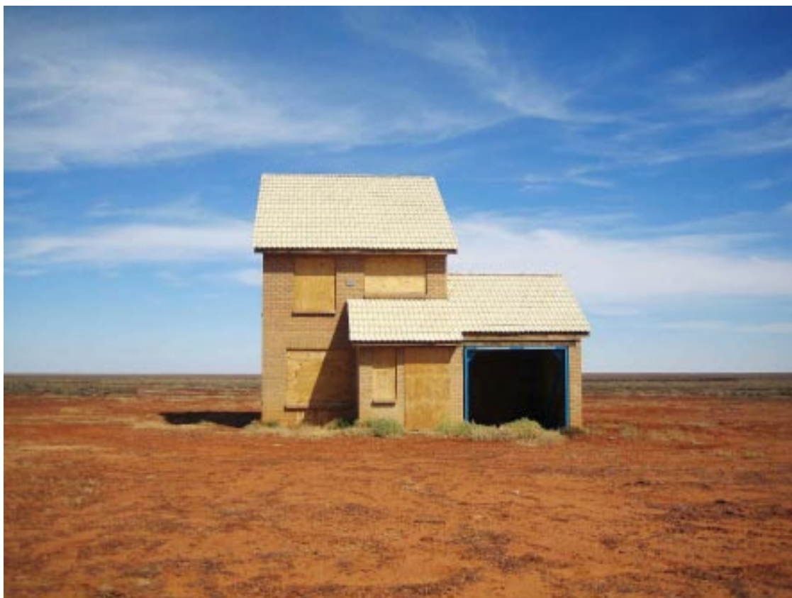
I öknen utförs fortfarande sprängtester, här ett modellhus av engelsk typ som utsätts för detonationer på olika avstånd för att man ska kunna testa byggnadens strukturella hållfasthet. Foto: Gunilla Bandolin.
