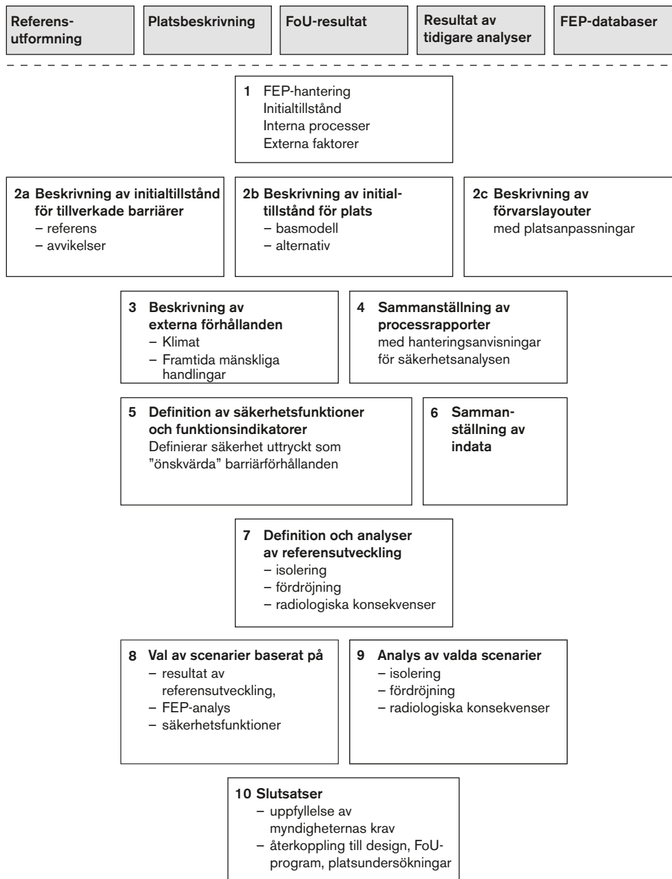
Figur 4-1. Översikt av de tio huvudstegen i säkerhetsanalysen SR-Can. Rutorna ovanför den streckade linjen visar indata till analysen.
