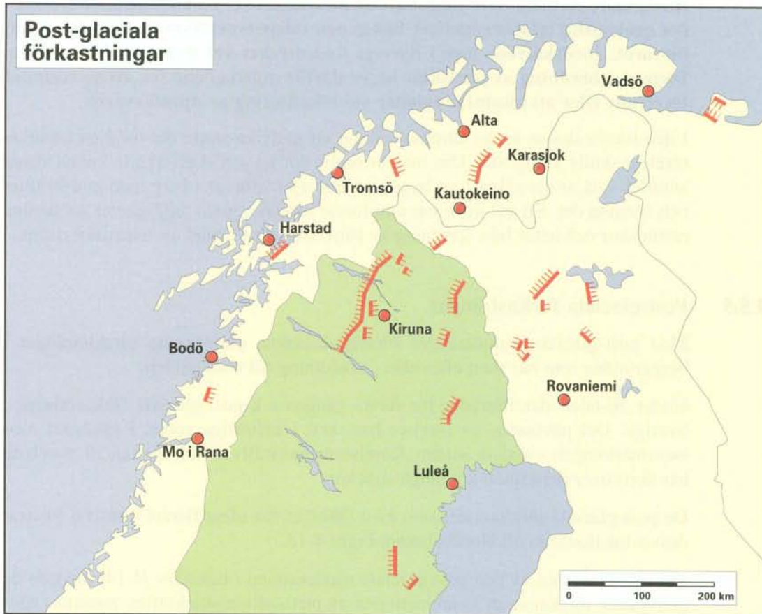
Figur 4-13. Lägen av post-glaciala förkastningar i norra Europa. Bearbetad efter [4-24]. Den skillnad som finns i observerad frekvens av post-glaciala förkastningar mellan södra och norra Sverige är inte grund för att framhålla eller utesluta regioner vid lokaliseringen.
