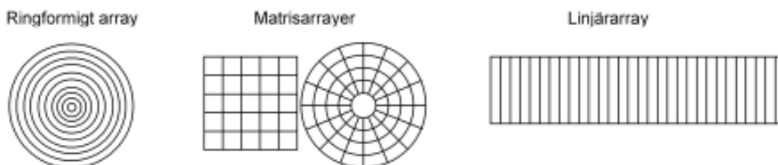
Figur 5-5. Schematisk skiss över olika arraysökare.
