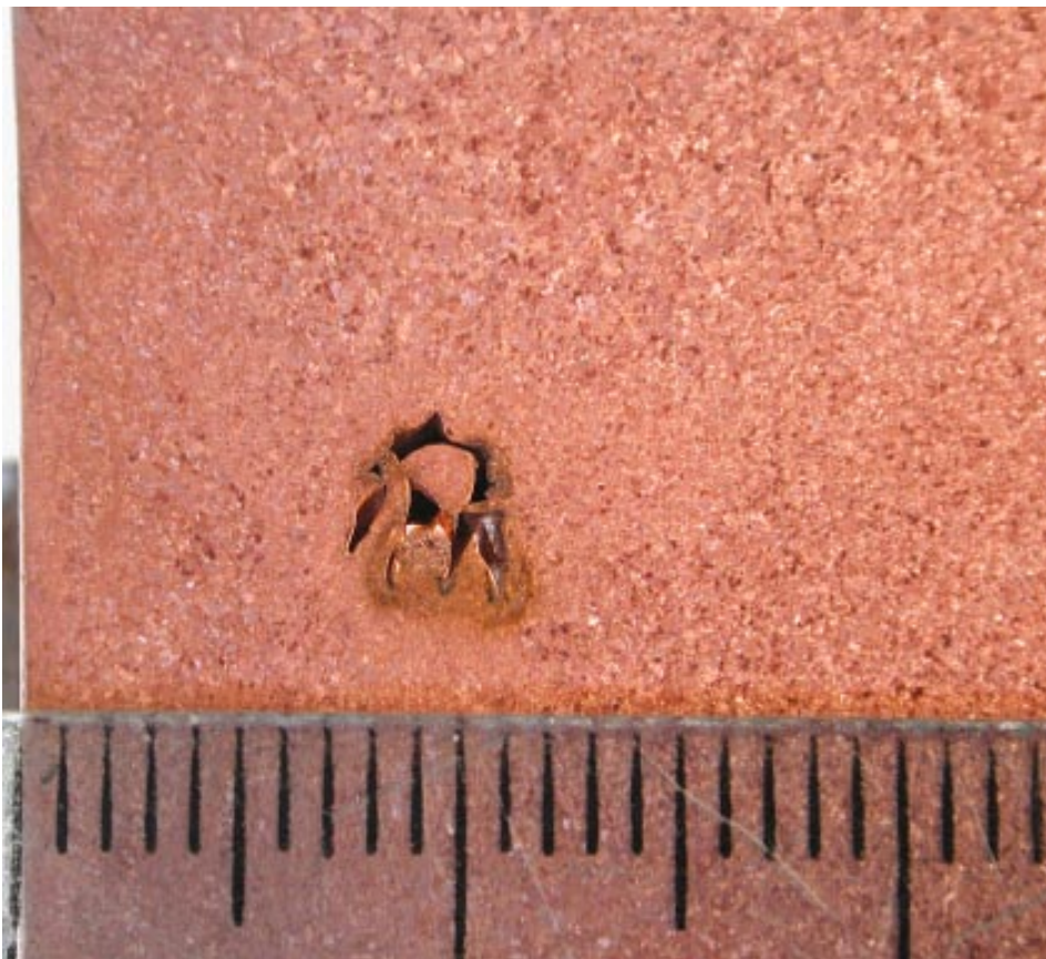
Figur 6-4. Makroprov av inre hålighet.
