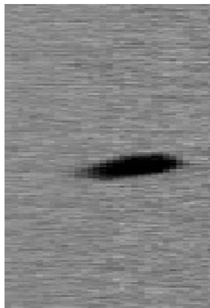
Figur 6-9. Radiografering av inre hålighet.
