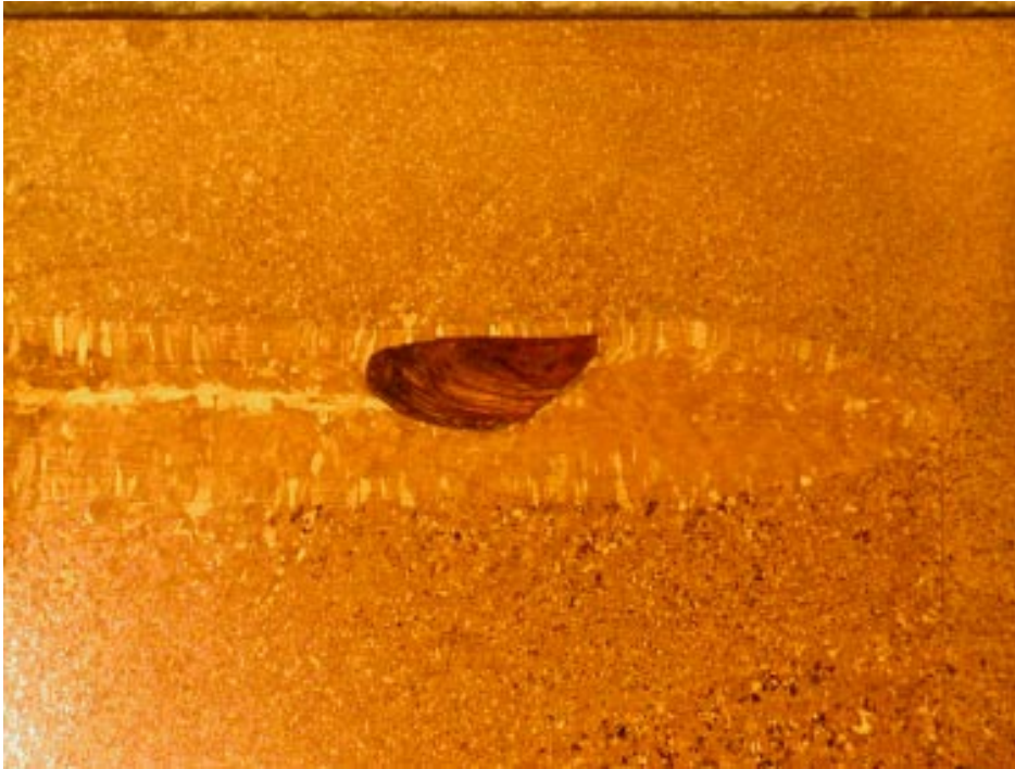
Figur 6-7. Makroprov av inre hålighet.
