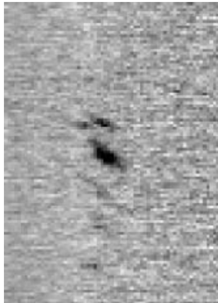
Figur 6-6. Radiografering av inre hålighet.
