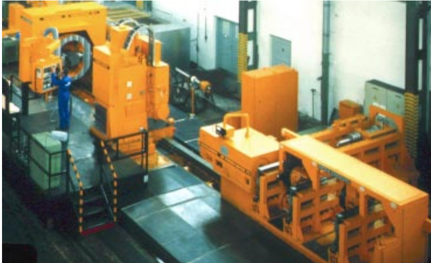
Figur 6-4. CNC-svarvfräs typ PC4, med torn och verktygsväxlare.
