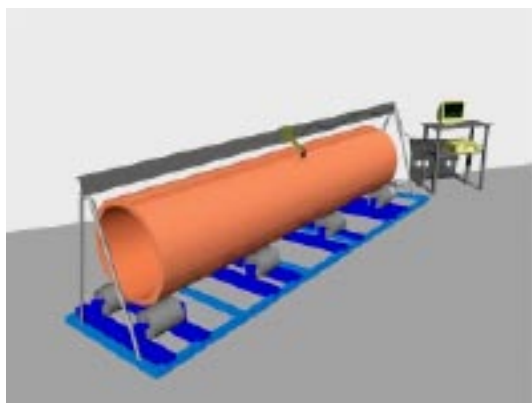
Figur 6-8. Schematisk bild av ultraljudsundersökning av ett kopparrör.
