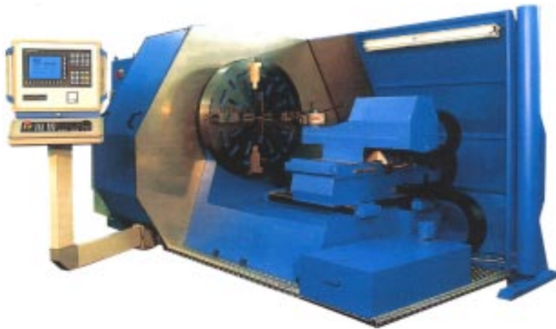
Figur 6-6. CNC-svarv för bearbetning av lock och botten i koppar.
