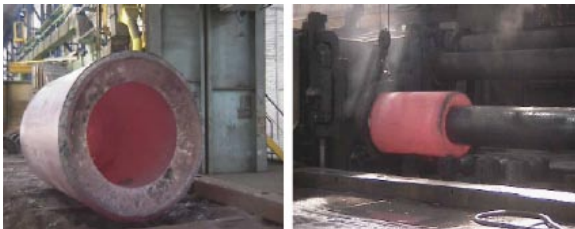
Figur 4-2. Bilden till vänster visar ett hålvt varmt kopparämne som i den högra bilden sitter på dornen och pressas genom matrisen i en så kallad dragoperation.
