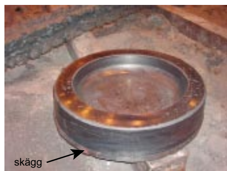
Figur 5-1. Färdigsmitt ämne till kopparlock/botten, med överskottsmaterial eller skägg.
