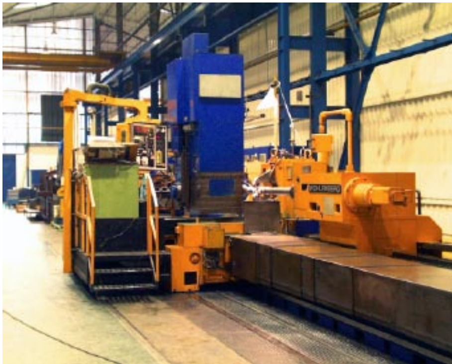
Figur 6-7. Maskin för svarvfräsning av insatsen. Den blå enheten på bilden utgör fräsenhet, även kallad tornet. Till höger framgår den gula dubbdockan.
