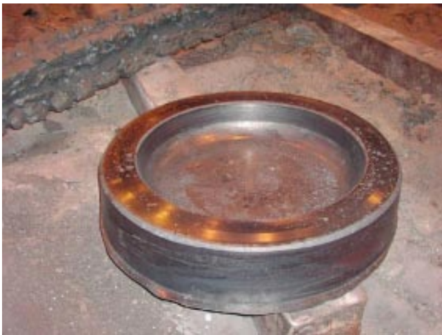
Figur 4-4. Bilden visar ett smitt ämne till kopparlock eller botten.
