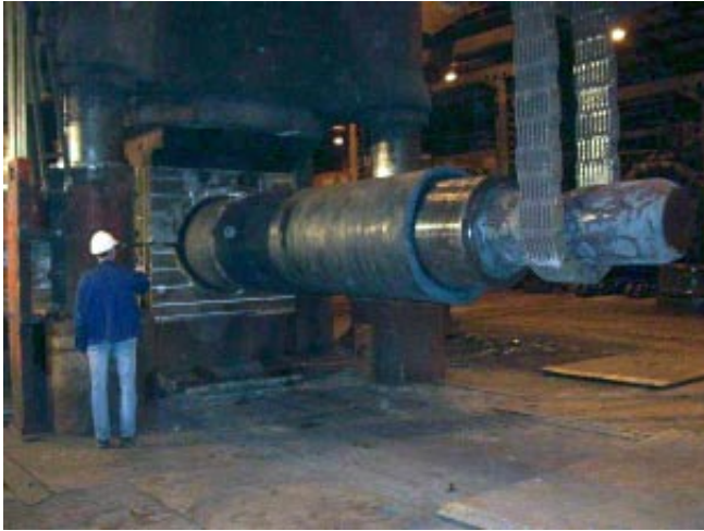
Figur 4-3. Smidningen av kopparröret avslutas med räcksmidning på dorn.
