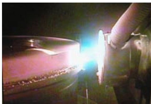
Figur 4-2. EBW på Kapsellaboratoriet.
