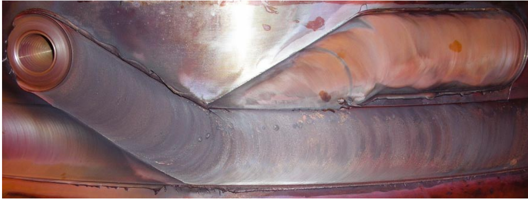
Figur 7-3. Svetsningen startas och avslutas ovanför foglinjen, detta område bearbetas bort.
