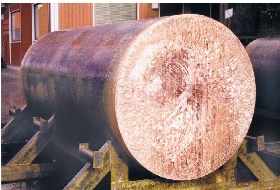
Figur 6-1. Koppargöt för extrusion av kopparrör.
