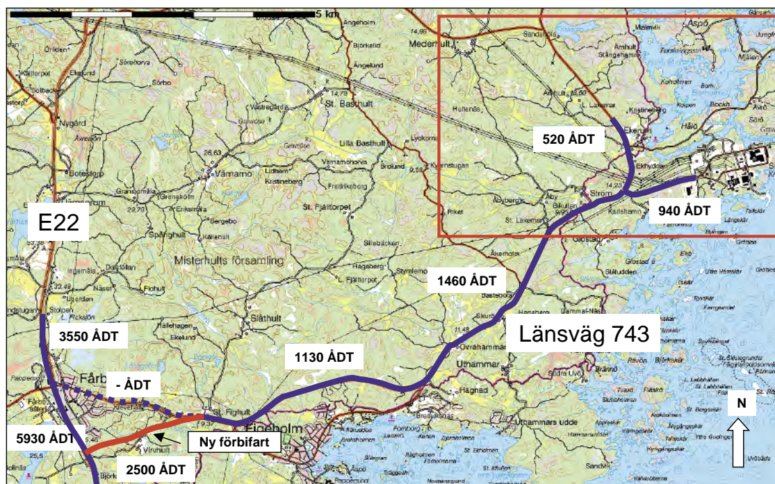
Figur 3-1. Dagens trafik längs väg 743 angivet som årsdygnstrafik (ÅDT) samt ny förbifart vid Fårbo som öppnades för trafik 2005. Område för bullerberäkningar och antal boende. Rödmarkerat utsnitt se figur 3-2. 2 500 ÅDT kommer från gamla genomfarten genom Fårbo. Inga trafiksiffror finns för den nya förbifarten.
