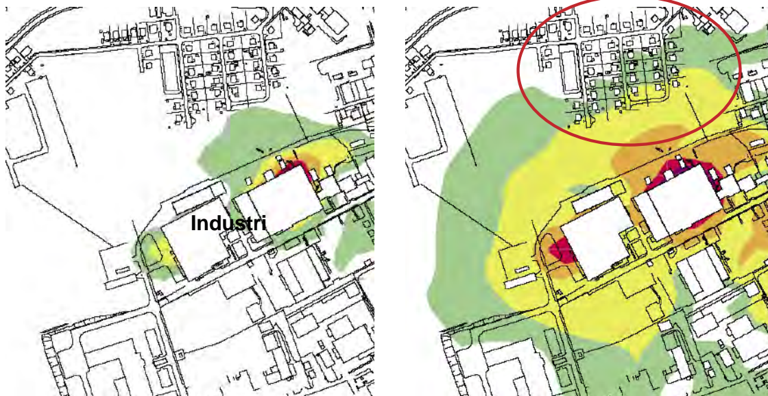
Figur 4-9. Exempel avseende ekvivalent ljudnivå utomhus för dag (tv) respektive natt (th), dvs gränsen mellan grönt och gult fält motsvarar 50 respektive 40 dBA.
