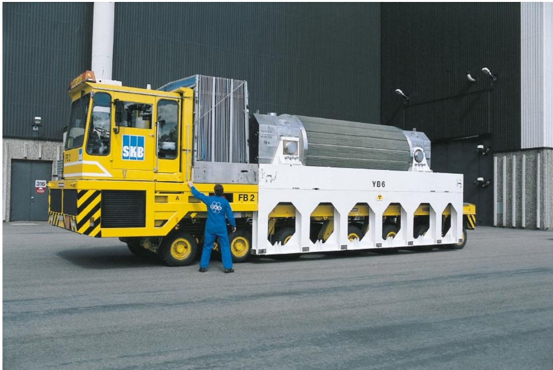
Figur 3-4. Terminalfordon med transportbehållare.
