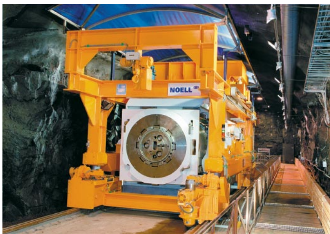
Figur 3-3. Demonstrationsanläggningen i Äspölaboratoriet med uppställd deponeringsmaskin.
