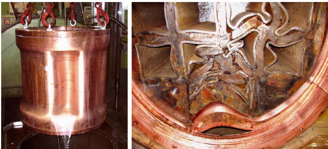
Figur 2-5a och b. Provkapsel nr 2 efter kollaps vid tryckbelastningen 139 MPa.
