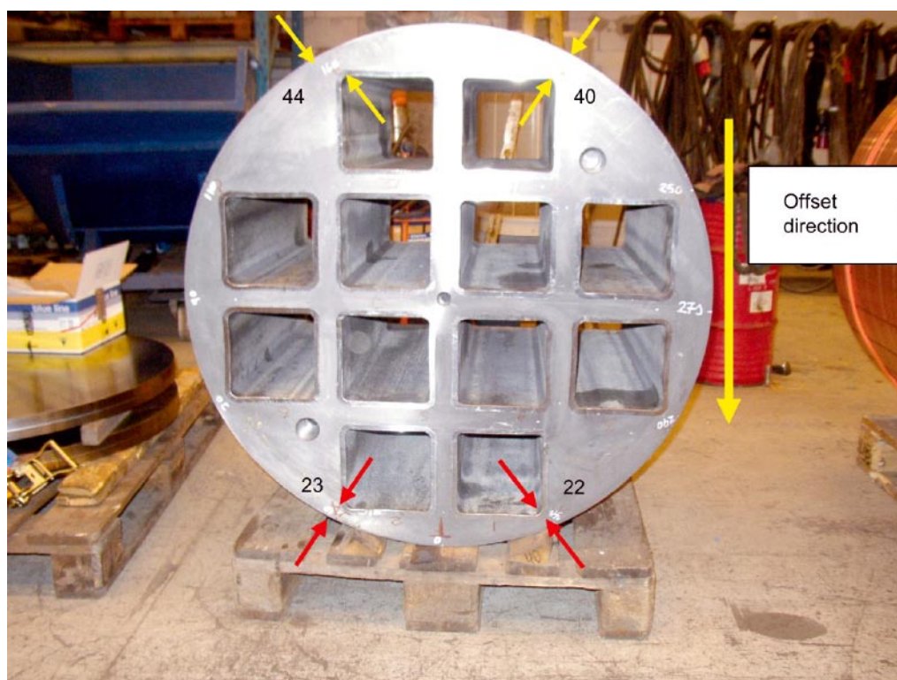
Figur 2-6. Tvärsnitt av insatsen I 26 med variationer i vägg tjocklek beroende av kassetterns förskjutning från centrum.
