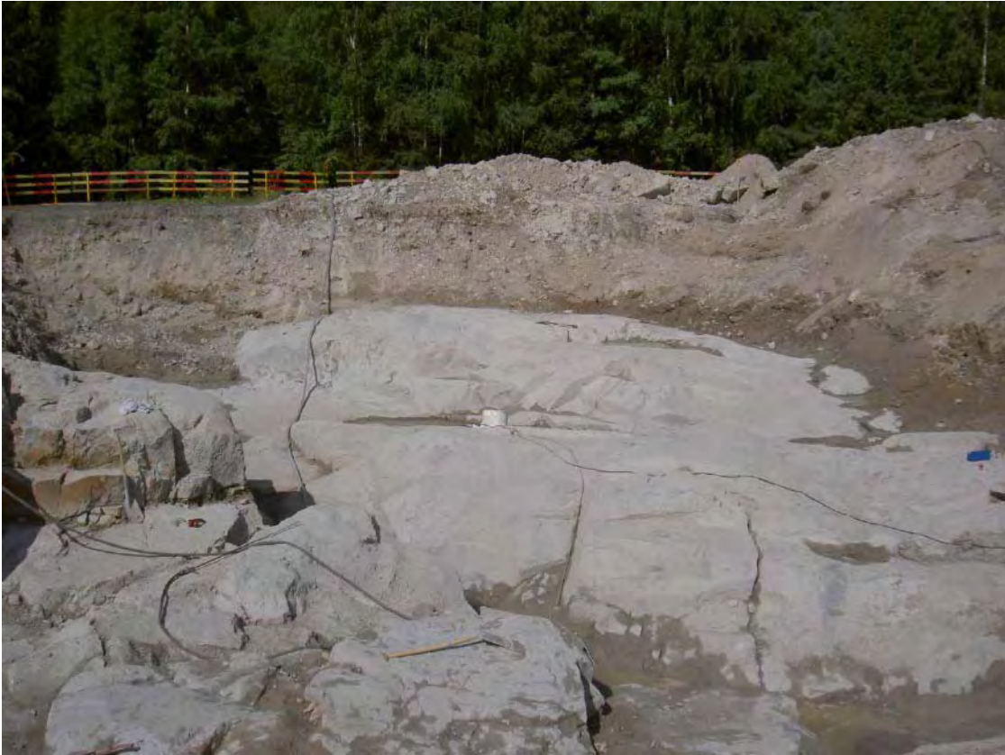
Figur 4-4. Bergytan i provgropen.
