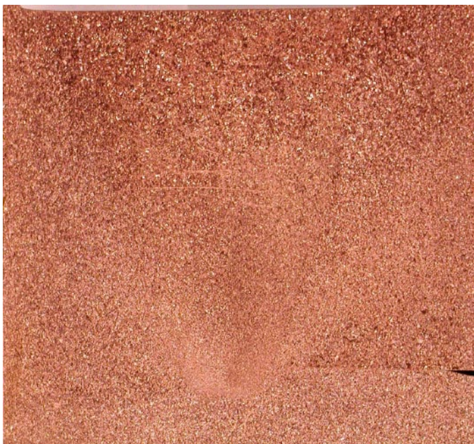
Figur 5-4. Tvärsnitt från locksvets 2.
