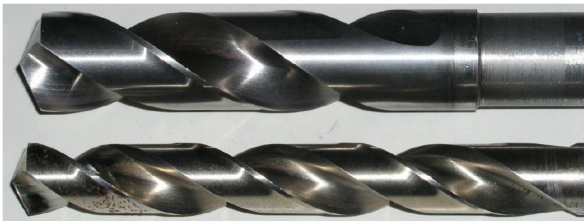
Figur 4-3. Ursprunglig och nuvarande borr med en diameter på 20 respektive 15 mm.
