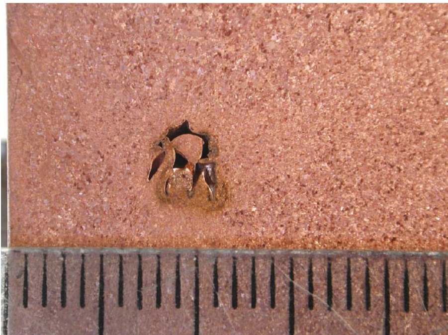
Figur C-3. Makroprov av inre hålighet.
