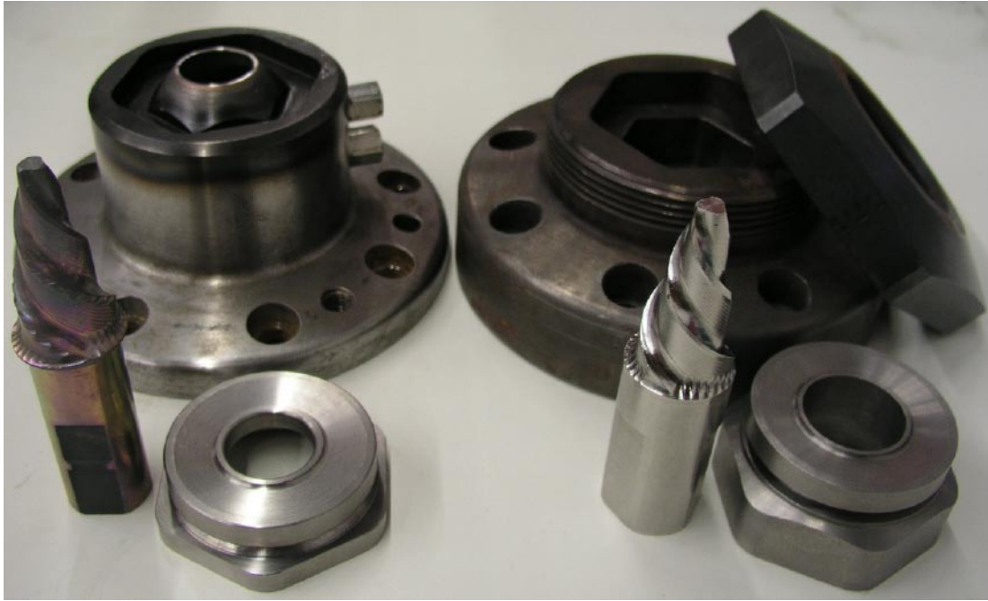
Figur 4-6. Ny och gammal (till höger) utformning av tapp, skuldra och verktygshållare.
