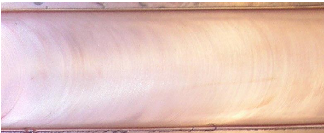
Figur 4-8. Yta vid svetsning med vattenglykolånga närvarande.
