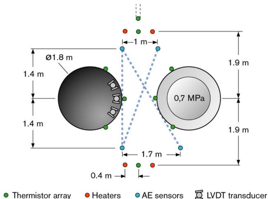
**Figur 2** Planvy av experimentgeometrin. I det öppna hålet till vänster illustreras LVDT givarna och stålkonstruktionen de är monterade på, hålet till höger i figuren är det som var trycksatt. Lägena i horisontalplanet för värmarna, temperaturgivarna och det akustiska systemet är också de markerade i figuren.
